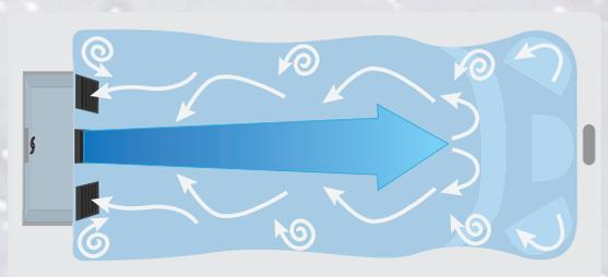
Turbulenzen beim Einsatz eines Propellersystems
